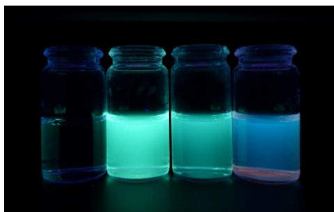
Figuur 12: 5-ASA-oplossingen bij verschillende pH-waarden onder UV-licht ( \lambda = 365 \text{ nm} ), van links naar rechts: pH 3, 7, 12, 14.
