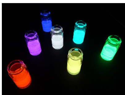
Figuur 10: Additieve kleurmenging gedemonstreerd met fluorescerende oplossingen uit alledaagse producten (onder UV-licht, \lambda = 365 \text{ nm} ). In de hoeken van het denkbeeldige driehoek bevinden zich de drie basiskleuren; in de middenpunten van de zijden de mengkleur van mengkleur van de naastliggende basiskleuren en in het midden van de driehoek een mengsel van alle drie basiskleuren.
