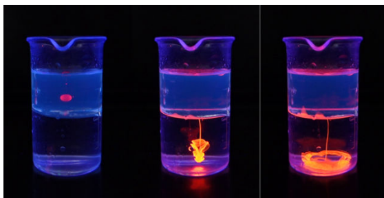
Figuur 13: De kleurstofoplossing passeert de olie (links) en barst aan de grens tussen de olie en het water (midden en rechts).
