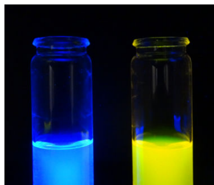
Figuur 1: Onder UV-licht ( \lambda = 365 \text{ nm} ) fluoresceert een ethanolische pyranine-oplossing blauw (links), terwijl een ethanolische oplossing van eosine Y geel fluoresceert (rechts).
